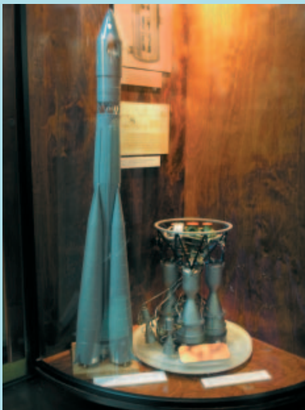
Макет ракеты-носителя «Восток», сконструированной С.П.Королёвым. Рядом — макет жидкостного ракетного двигателя РД-107, разработанного под руководством В.П.Глушко.
