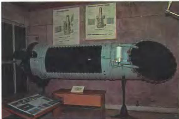
*Ультрафиолетовый телескоп «Спика» автоматической станции «Астрон».*
