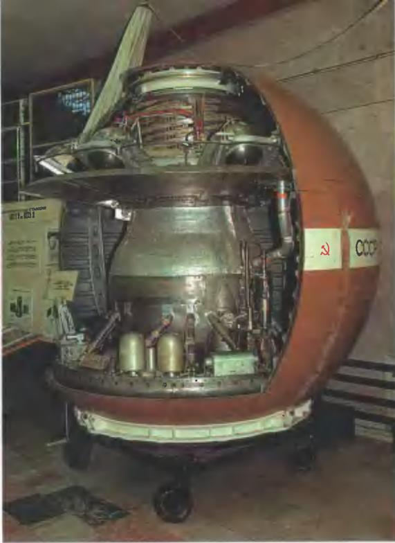
*Посадочный аппарат автоматической межпланетной станции «Вега».*
