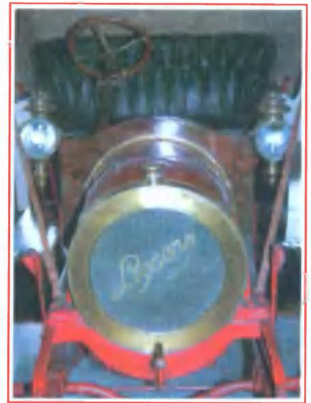
*Заря автомобилестроения — время экспериментов. В 1908 году на заводе «Фиата» опробовался столь необычный радиатор.*
