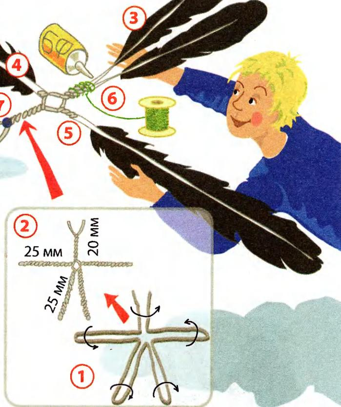
ре. Для этого на выступающую часть носа модели крепится кусочек пластилина (7). Запуская планёр раз за разом, мы то отщипывали немного, то добавляли пластилин, корректируя центр тяжести, а значит, и траекторию полёта.
