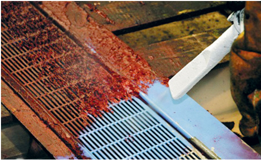
Криогенный бластинг жидким азотом — эффективный, экологически чистый и безопасный способ очистки поверхностей.
