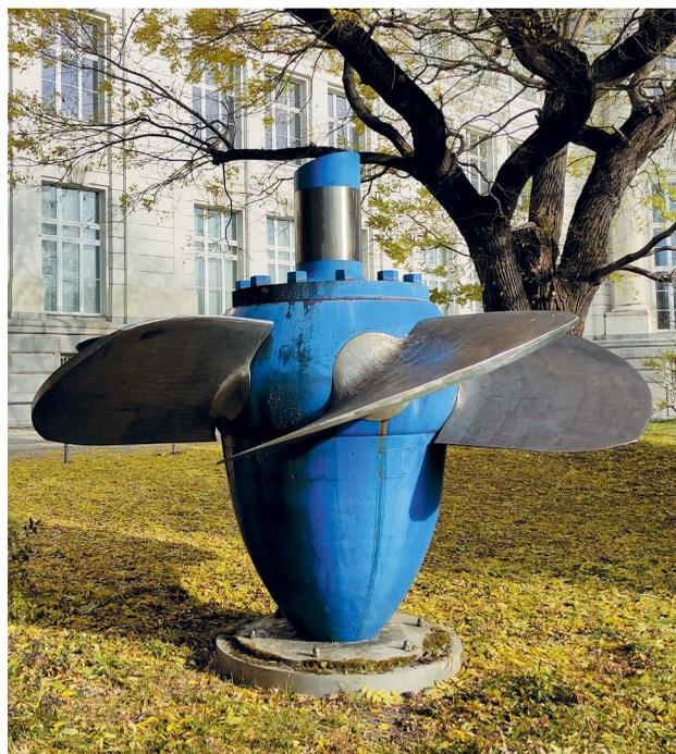
***Лопастная гидротурбина Виктора Каплана — сердце первых гидроэлектростанций!***
