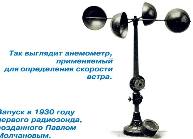
*Так выглядит анемометр, применяемый для определения скорости ветра.*
