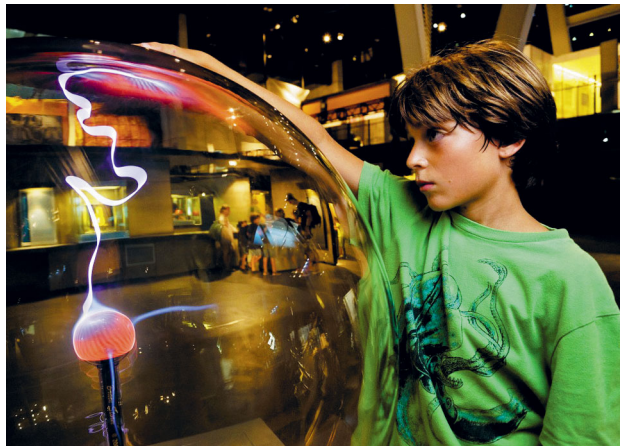
Увлекательная игра с электрическими разрядами в плазменном шаре, наполненном разреженным газом и снабжённым электродом.
