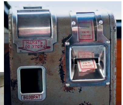
Кассовый аппарат с рычажной системой выдачи билета.
