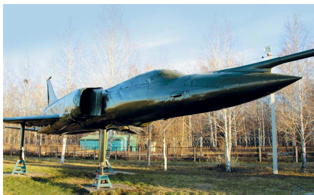
Аэродинамическая, необходимая для наземных испытаний модель тяжёлого сверхзвукового самолёта Ту-22.
