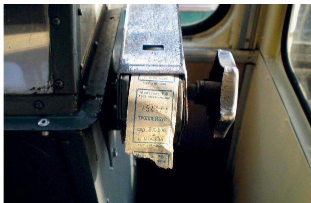
Кассовый аппарат с колесной системой выдачи билета.
