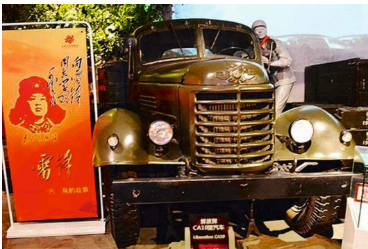
Советский труженик ЗИС-150 стал прототипом китайской модели тяжёлого грузовика Jiefang CA-10.
