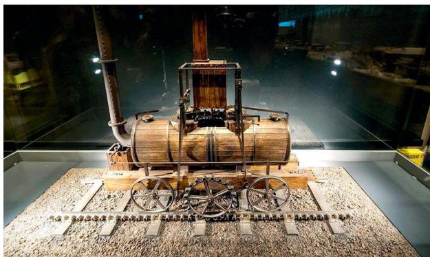
**Такие паровозики на зубчатых колёсах применяли в XIX веке на горных разработках. Зубцы позволяли легче тормозить на спусках с горок.**
