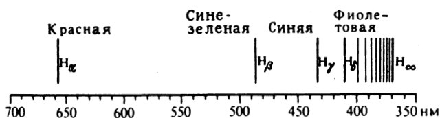
Р и с. 7. Линии видимого спектра атомного водорода (серия Бальмера)
