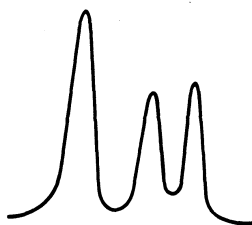
Р и с. 95. Спектр ЯМР (протонов) этанола \text{C}_2\text{H}_5\text{OH}
