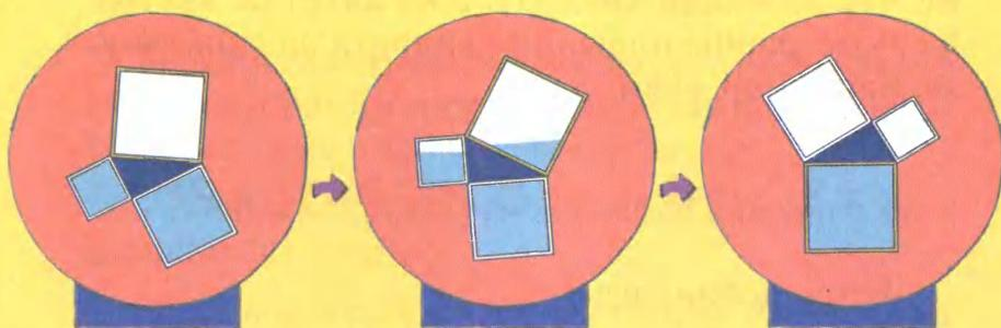
Когда конструкция поворачивается, жидкость перетекает из двух меньших квадратов в большой.
