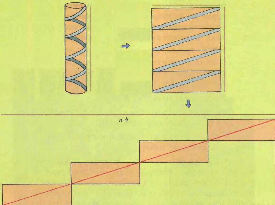
– Ширина каждой развернутой секции спирали равна окружности основания цилиндра. Если мы составим вместе все развернутые секции так, чтобы диагонали образовали прямую, то получится прямоугольный треугольник с катетами длины  $h$  и  $n2\pi r$ .
