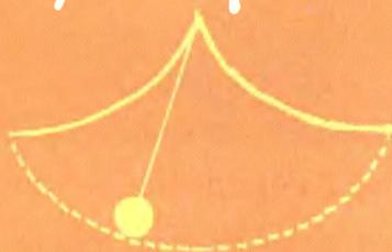
Перевернутая циклоида имеет ещё одно свойство. Время, за которое точечная масса, двигаясь по ней под действием силы тяжести, достигает нижней точки, одно и то же независимо от точки начала движения. Кривая, обладающая этим свойством, называется таутохроной.
