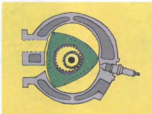
– Правильно, и эта капсула называется цилиндром двигателя, а треугольник Рело внутри него – ротор, – продолжает Кодзи.
