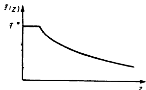
Рис. IX.5. Оптимальный температурный профиль для обратимой экзотермической реакции.
