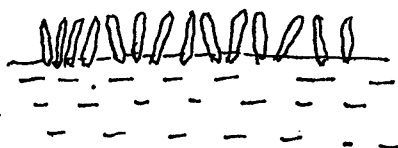
Мономолекулярный слой ПАВ на поверхности воды.
