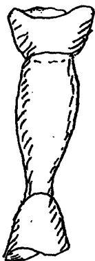
Жидкая перемычка между двумя твердыми стержнями (опыт Рэлея).
