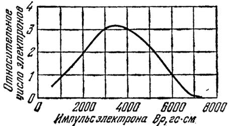
Рис. 36В.  $\beta$ -спектр  $P^{32}$ , показывающий распределение электронов по импульсу.
