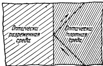
Рис. 34А. Полное отражение плоской электромагнитной волны на поверхности раздела двух сред с различными показателями преломления.
