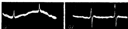
Рис. 8. Результат, полученный при использовании секции волновода с прорезью: а) образец DPPH весом 20 мг и усилитель (рис. 6), б) образец DPPH в 20 мг и усилитель с двойной T-связью.
