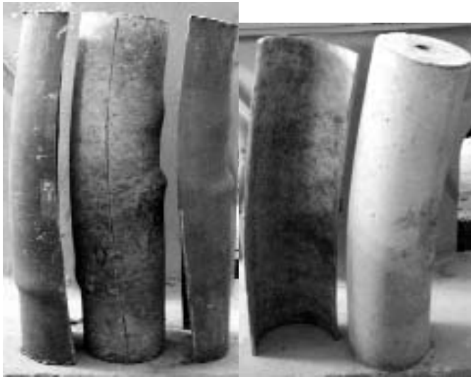
Рис. 2. Характер разрушения трубобетонных элементов
