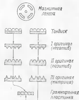
Рис. 30. Технологическая схема гальванопластического размножения оригиналов
