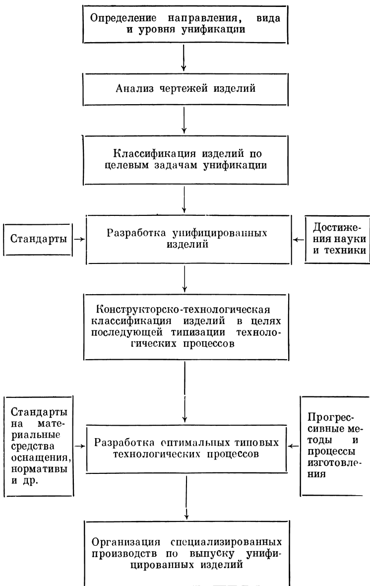
Рис. 3. Последовательность выполнения комплекса работ по унификации изделий
