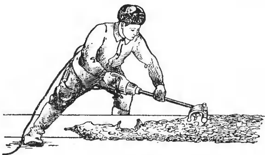
Рис. 21. Окорка бревна электроинструментом РЭС-2.
