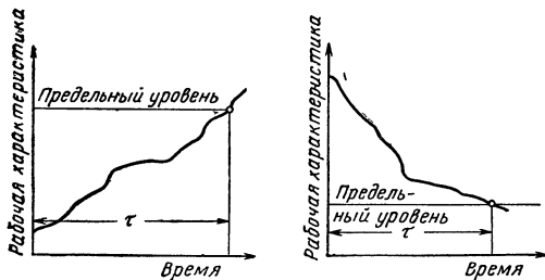
Рис 12. К определению времени безотказной работы при монотонном изменении рабочей характеристики
