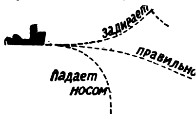
Рис. 16. Схема типовых траекторий планера при регулировке продольной устойчивости.
