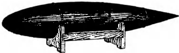
Рис. 2. „Аэродинамическое тело“ наилучшей обтекаемости. Маленький кружок в середине его, поставленный перпендикулярно к движению, оказывает в воздухе такое же сопротивление, как и все тело.
