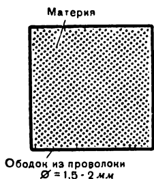
Рис. 19. Сетка для осветительного прибора. Размер сетки устанавливается в зависимости от размера светящейся поверхности источника света. Материал сетки пропитывается негорючим составом
