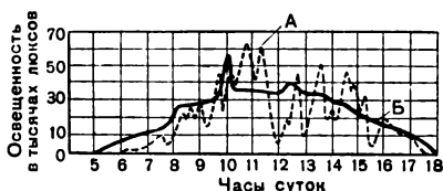
Рис. 31. График изменений освещенности точки земной поверхности в течение дня при пасмурной погоде
