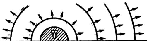
Рис. 2.3. Распространение ударной волны при наземном ядерном взрыве
