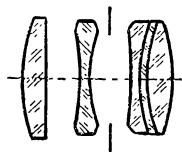
Рис. 57. Оптическая схема фотообъектива «Индустар»
