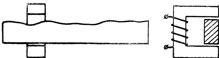
Рис. 22. Индуктивное коррекционное устройство
