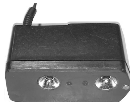
Рис. 6. Внешний вид оптического пульта управления в сборе.
