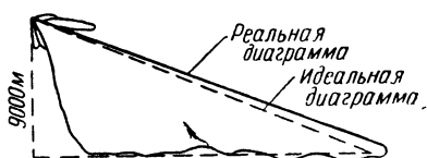
Фиг. 219. Диаграмма направленности антенны станции APQ-13 в вертикальной плоскости.
