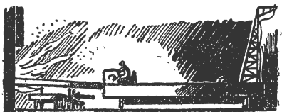
Завалочная машина подъезжает к мульте и вводит ее в мартеновскую печь.
