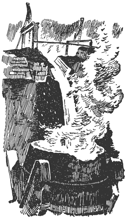
Выдача чугуна из доменной печи.
