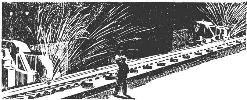
Пилы распиливают рельсы на куски.
