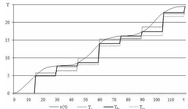
Рис. 2. Представление процесса дискретизации непрерывного сигнала накопленными суммами.
