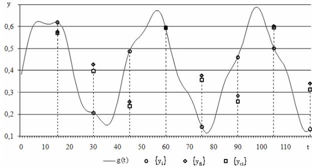
Рис. 1. Дискретизация непрерывного сигнала с мгновенным, средним и прикладным функциональным оцениванием.
