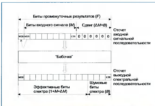
Рис. 3. Диаграмма битов входного сигнала и выходного спектра
