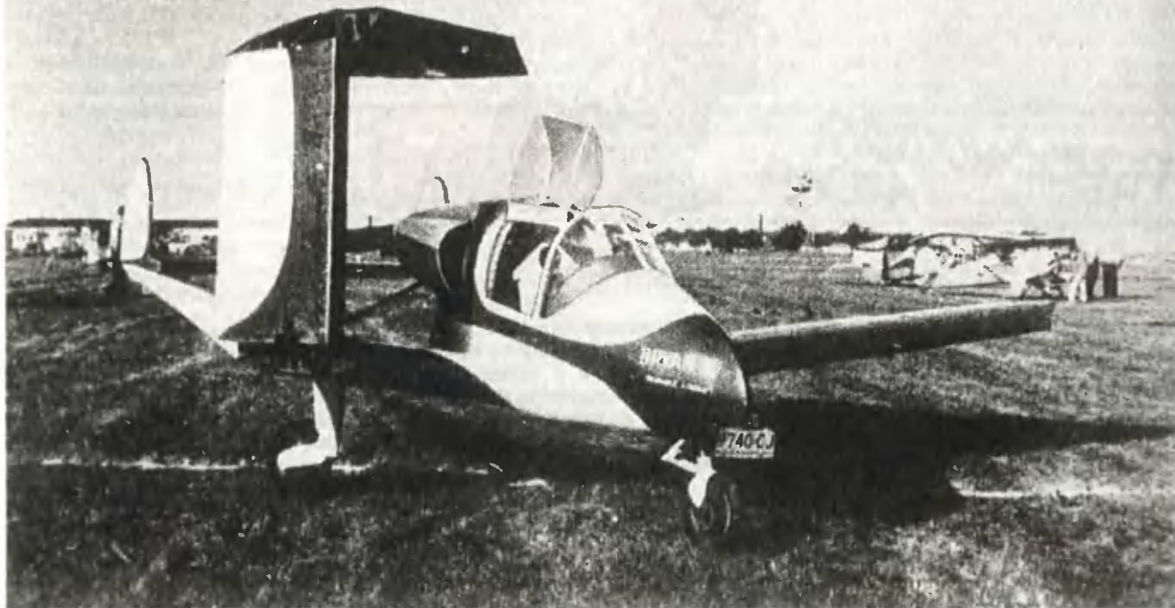
Самолет-автомобиль «Родейл», построенный любителем Брайном из агрегатов стандартного самолета. Правое крыло сложено для движения по земле, левое — развернуто для полета.
