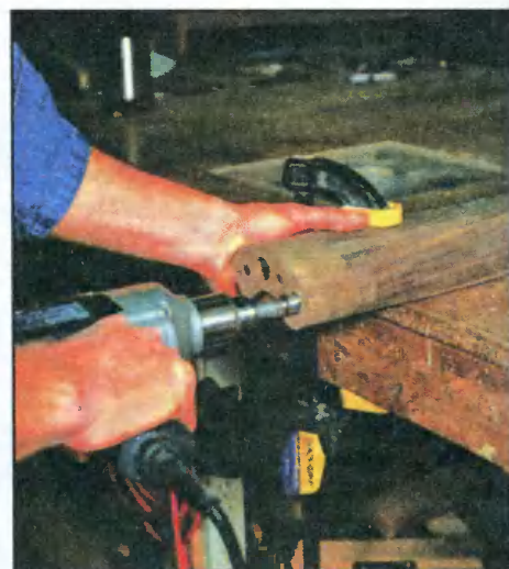
Фото 3. Высверливание отверстий под шканты.
