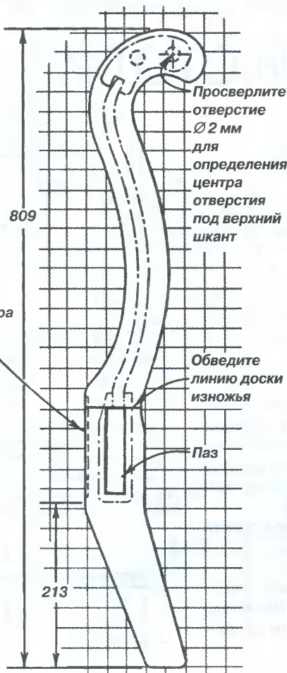
Рис. 8. Шаблон ножки изножья.
