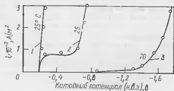
Рис. 31. Поляризационные кривые электроосаждения олова из кислых и щелочных электролитов при 25°C:
