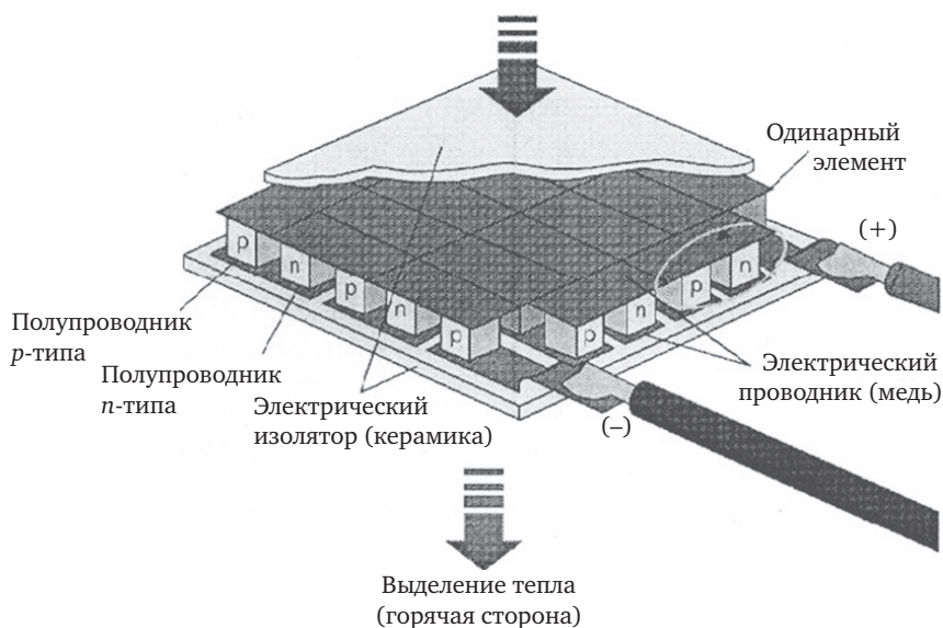
Рис. 3.12. Схема термоэлектрического модуля охлаждения на основе эффекта Пельтье
