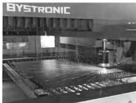
Рис. 13.31. Схема раскроя листа и установка лазерного раскроя фирмы "BYSTRONIC"
