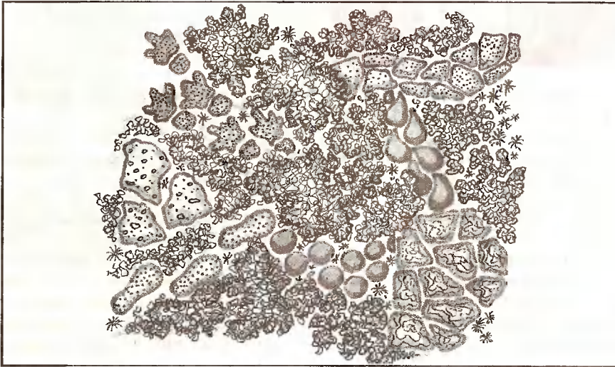
Рис. 4. Для удобства ходьбы «следы великана» заливаются с интервалом примерно 50 см. Готовые отливки увлажняют в течение 3-х суток.
