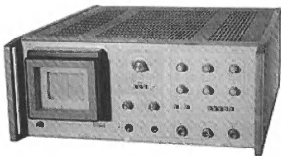
Рис. 4.14. Внешний вид скоростного осциллографа С7-19 без усилителя вертикального отклонения
