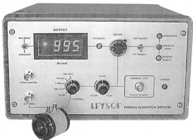
Рис. 3.99. 100 кГц Q-Switch драйвер фирмы Leyshop для быстрого управления ячейками Поккельса (время переключения до 3 нс)
