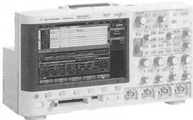
Рис. 5.61. Осциллограф смешанных сигналов серии X 3000 фирмы Agilent Technologies с четырьмя аналоговыми каналами
