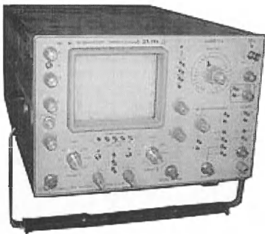
Рис. 4.21. Внешний вид 500-мегагерцевого скоростного осциллографа С1-104
