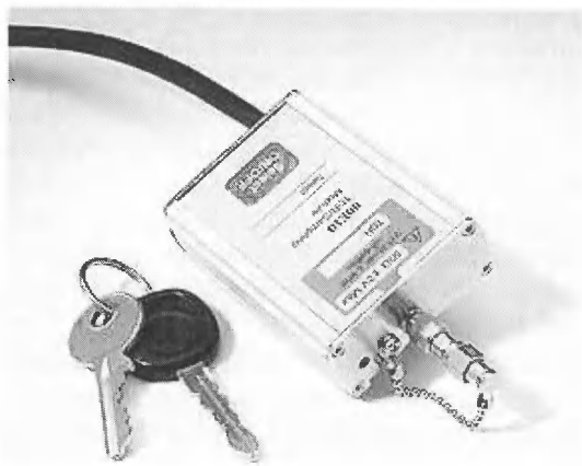
Рис. 5.99. Часть модуля TDR для подключения к источнику сигнала
