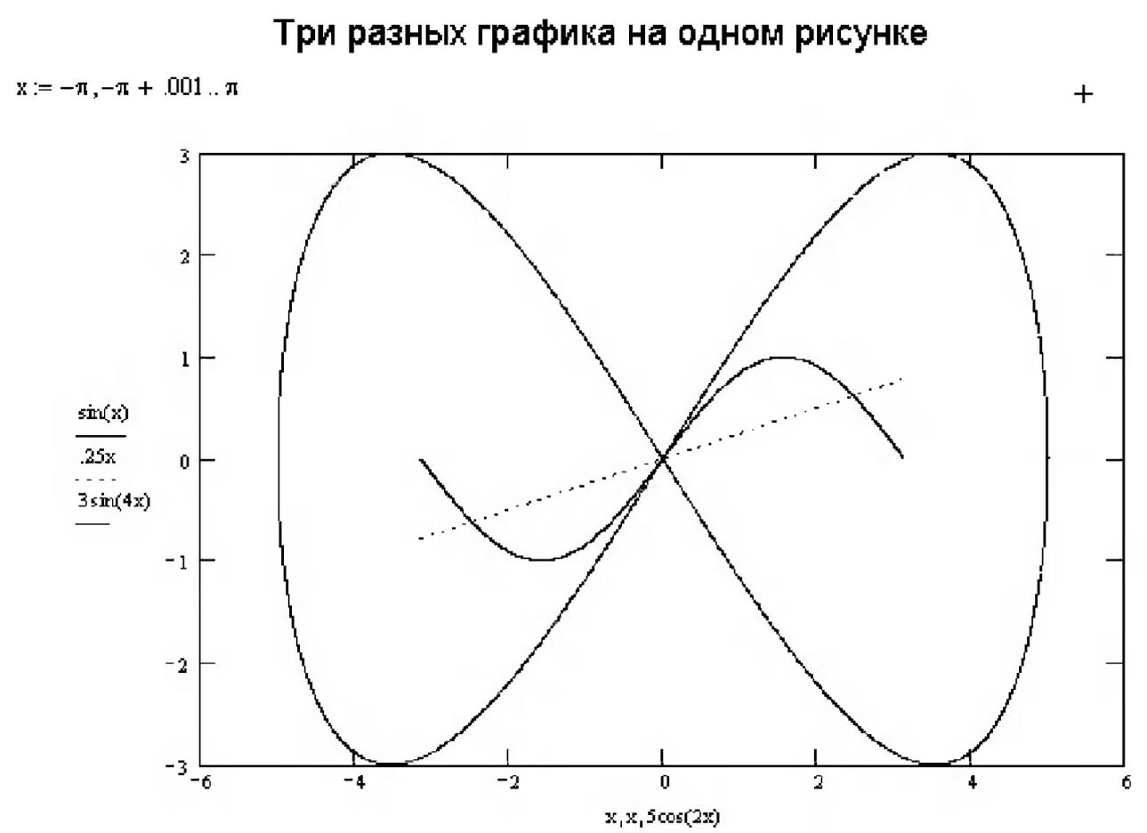
Рис. 13.4. Графики трех функций на одном рисунке – одна из них задана параметрически
