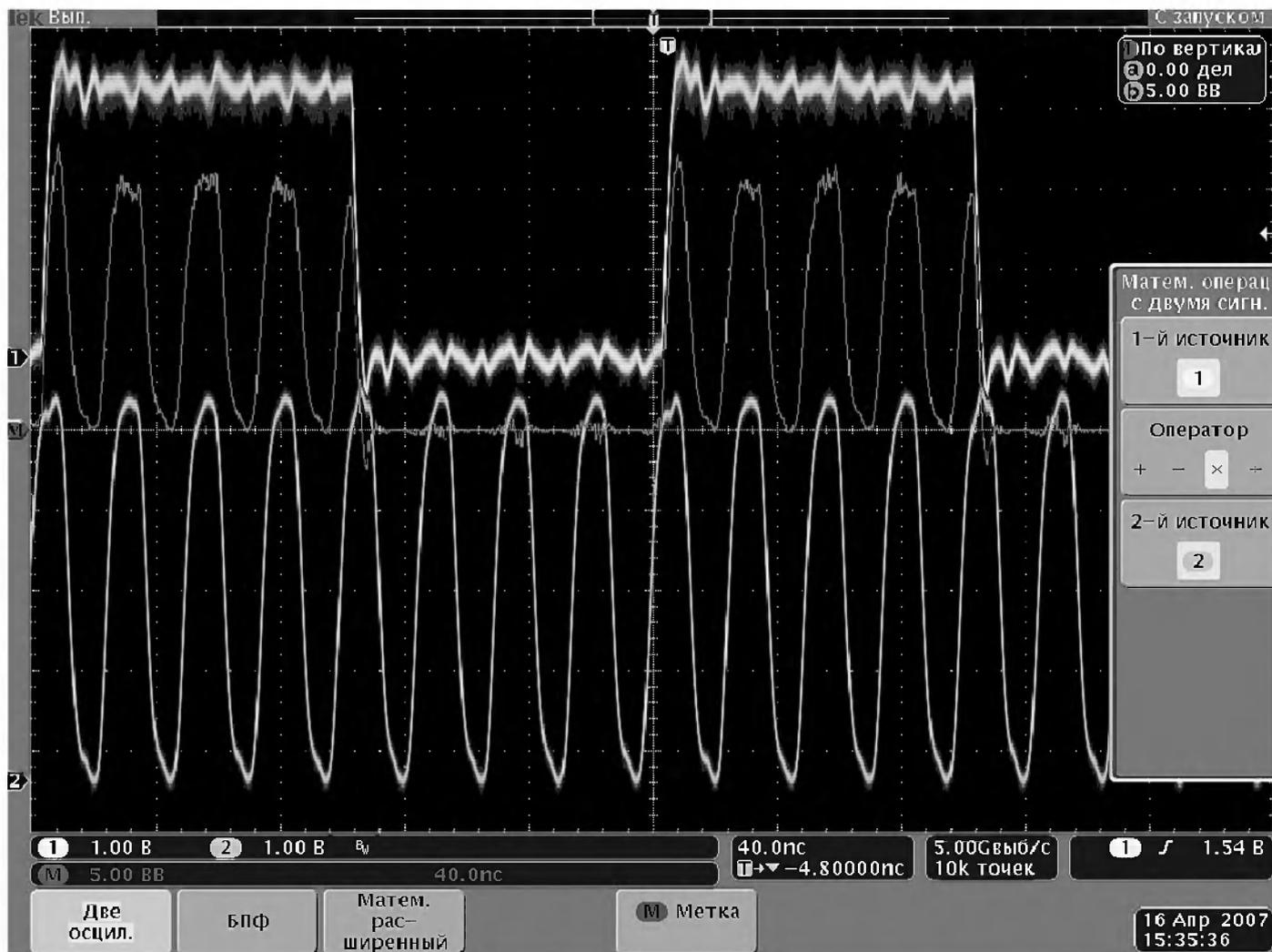
Рис. 1.39. Осциллограммы двух сигналов и результат их перемножения на экране осциллографа DPO4104
