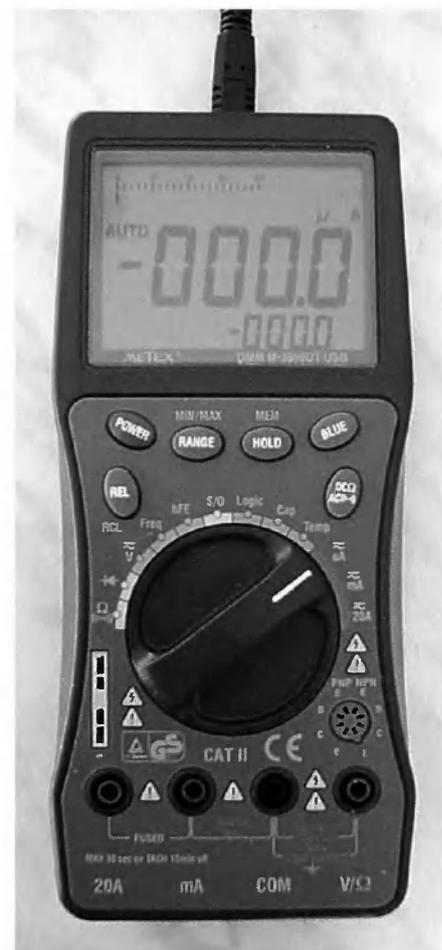
Рис. 1.37. Мультиметр M-3890DT с режимом True RMS и USB-портом для подключения к ПК (сверху)
