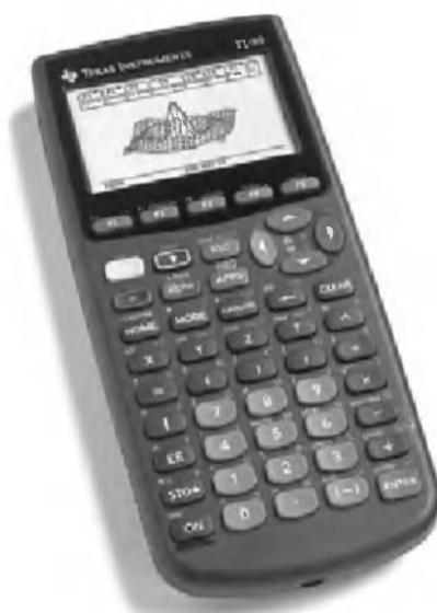
Рис. 1.30. Научные графические микрокалькуляторы TI-89 с встроенной СКА
