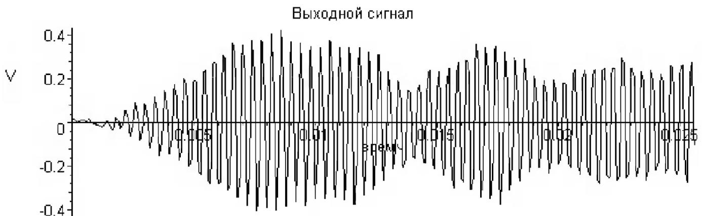
Рис. 15.36. Временная зависимость выходного сигнала цифрового фильтра
