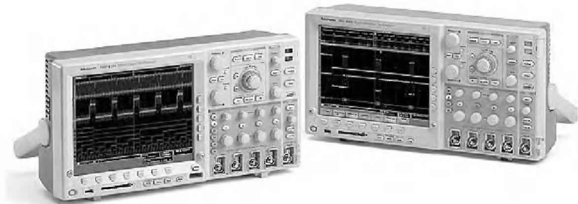
Рис. 1.38. Осциллографы серии DPO4000 (справа) и MSO4000 (слева)
