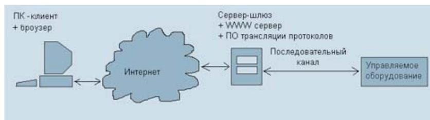
Рис. 1. Схема подключения оборудования к сети Интернет
