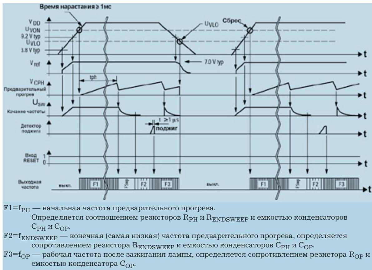
Рис. 4. Временные диаграммы работы электронного балласта
