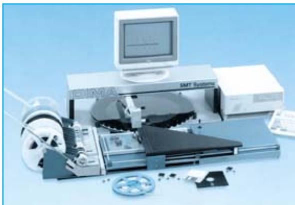
жатель печатной платы, автоматически индицирует место установки компонента. Производительность устройства SMMT-2000 — 600 компонентов в час.
