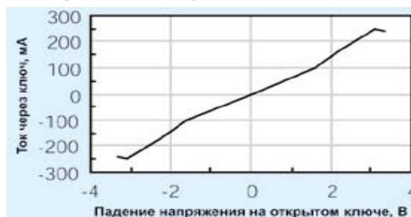
Рис. 2. Зависимость падения напряжения на открытом ключе от тока нагрузки
