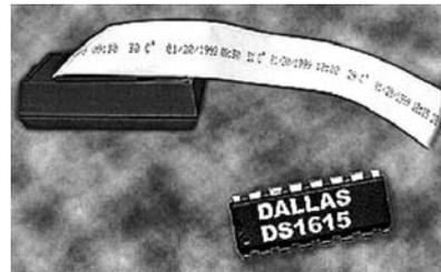
Новая микросхема фирмы Dallas Semiconductor DS1615 представляет собой первый в мире регистратор температуры, содержащий в одном кристалле часы реального времени, цифровой термометр, энергонезависимую память, управляющие цепи и последова-
