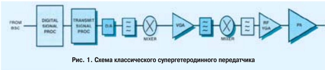
Рис. 1. Схема классического супергетеродинного передатчика
