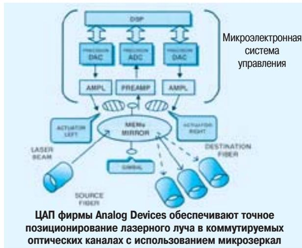
**Решение** → Фирма Analog Devices разработала большой набор высокоточных ЦАП, которые предназначены для использования в коммутируемых оптических каналах связи. Эти преобразователи имеют разрешение 14 и 16 разрядов. В одном корпусе содержится до 32 ЦАП, что позволяет минимизировать потребляемую мощность и габариты системы в целом.
