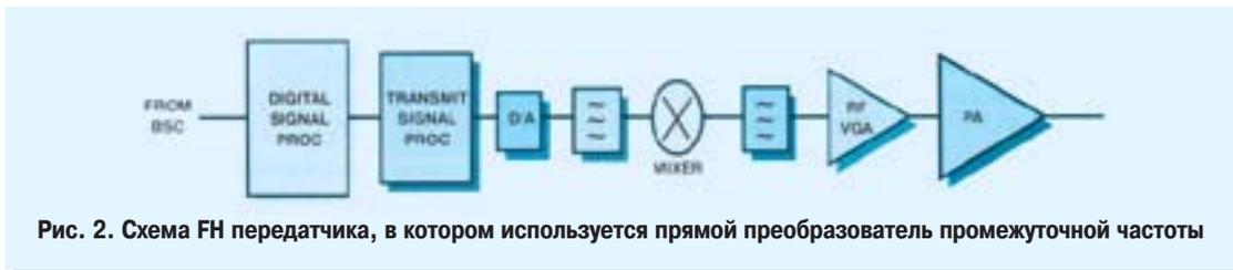
Рис. 2. Схема FH передатчика, в котором используется прямой преобразователь промежуточной частоты
