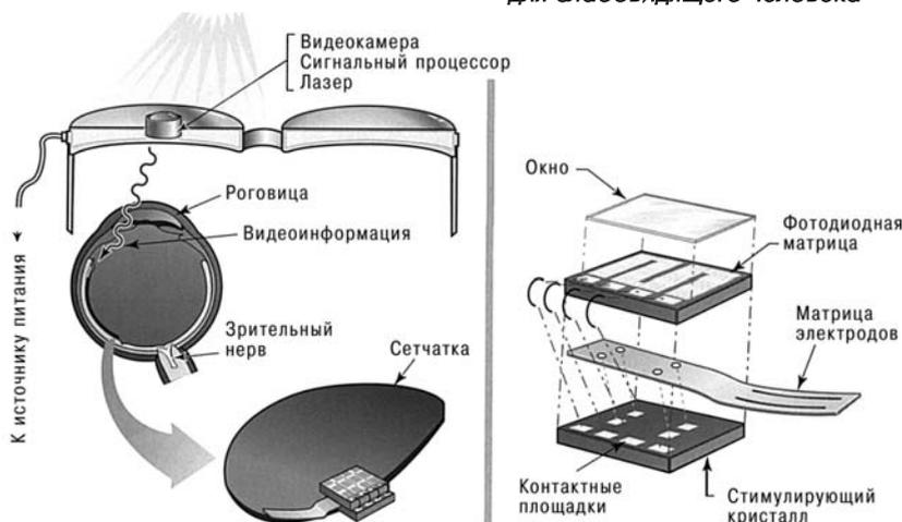
**Рис. 2. Элементы искусственного глаза на базе "кремниевой" сетчатки**
