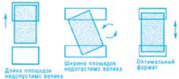
Рис. 3. Выбор конфигурации контактных площадок
