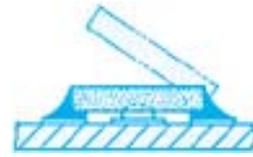
Рис. 2. Эффект "надгробного камня" при пайке чип-компонента
