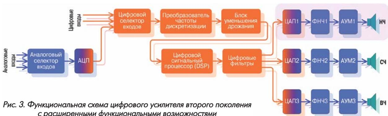
Рис. 3. Функциональная схема цифрового усилителя второго поколения с расширенными функциональными возможностями
