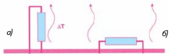
Рис. 6. Неправильная (а) и правильная (б) установка резистора на печатной плате
