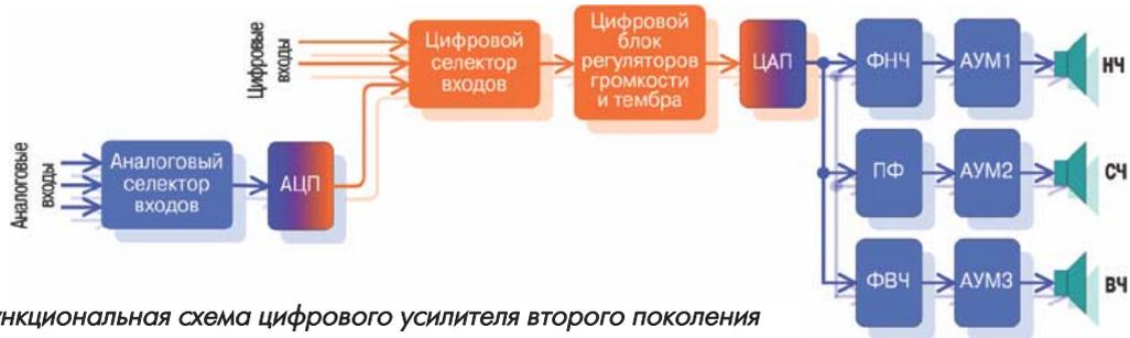
Рис. 2. Функциональная схема цифрового усилителя второго поколения
