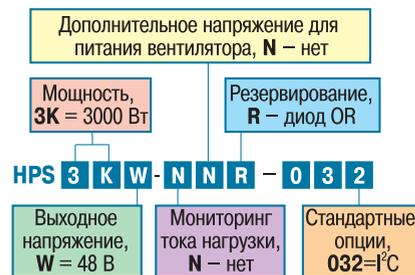
**HPS3KWNNR-032:** выходная мощность 3000 Вт, выходное напряжение 48 В, диод (OR) для параллельного включения, опция РС.
