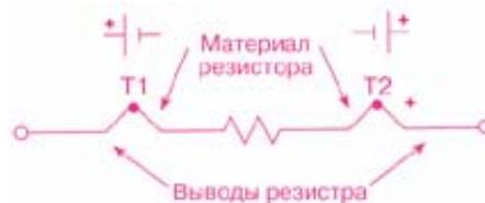
Рис. 5. Схема замещения резистора с паразитными термоЭДС
