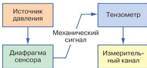
Рис. 1. Структурная схема преобразования давления
