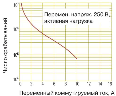
**Рис. 2. Зависимость числа срабатываний реле RTH от коммутируемого тока**
