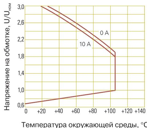
**Рис. 3. Зависимость допустимого напряжения на обмотке реле RTH от температуры**
