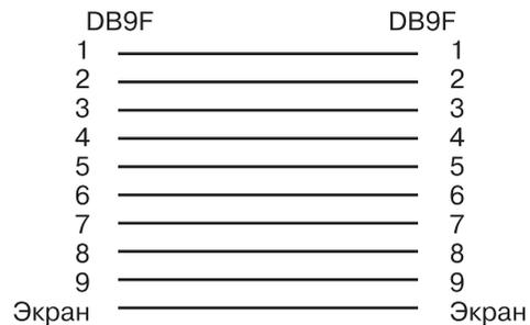
Рис. 4. Схема кабеля
