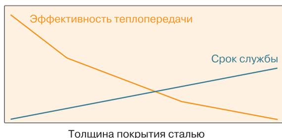
**Рис. 5. Зависимость теплопередачи и срока службы жала паяльника от толщины стального покрытия**
