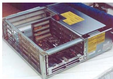
**Рис. 2. Применение соединителей DIN 41612**
