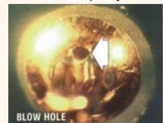
**Раковина в залитом припоем отверстиях**
