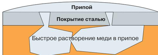
**Рис. 4. Проникание припоя через микротрещины стального покрытия жала**
