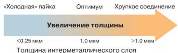
**Рис. 1. Толщина интерметаллического слоя как характеристика качества соединения**
