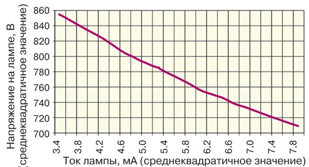
**Рис. 7. Вольт-амперная характеристика лампы**
