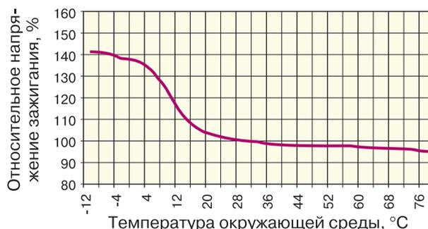
**Рис. 2. Зависимость напряжения зажигания лампы от температуры окружающей среды**
