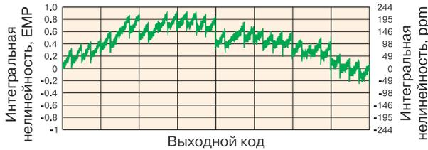
**Рис. 1. Зависимость интегральной нелинейности АЦП, выраженной в ЕМР и ppm, от выходного кода АЦП**
