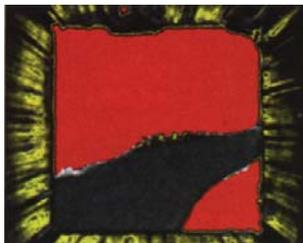
**Рис. 3. Акустическое изображение поверхности кристалла микросхемы в корпусе BGA (красным цветом обозначена зона расслоения между компаундом и кристаллом)**
